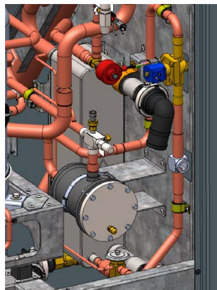
Screenshot del modello CAD 3D del chiller laser che mostra uno scambiatore di calore a piastre saldobrasate SWEP All-Stainless Q80ASx60.
