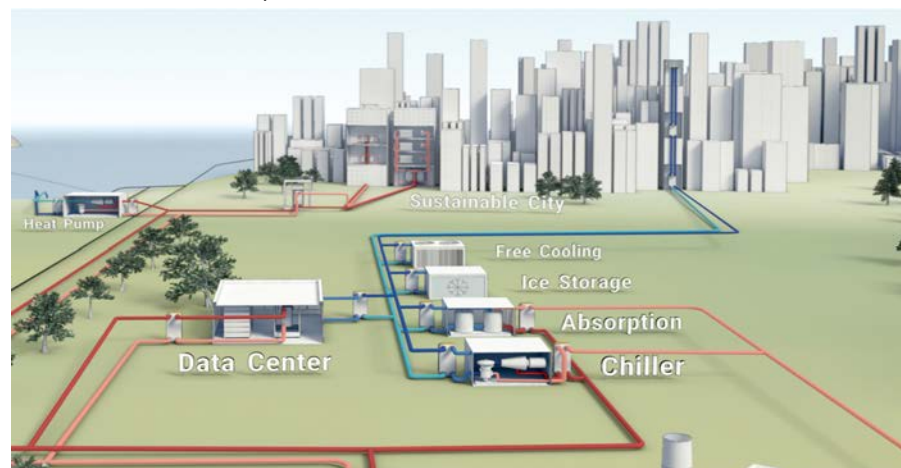
Diverse tecnologie di raffreddamento dei data center.
