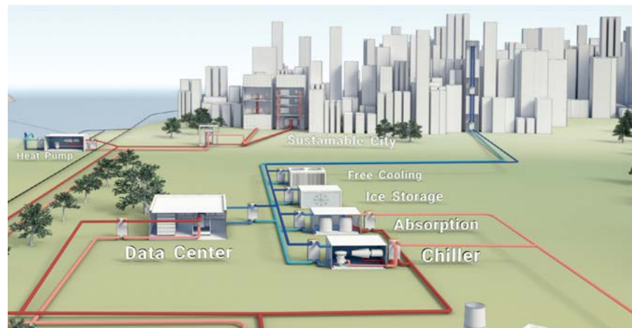
Diverses technologies de refroidissement de data center
