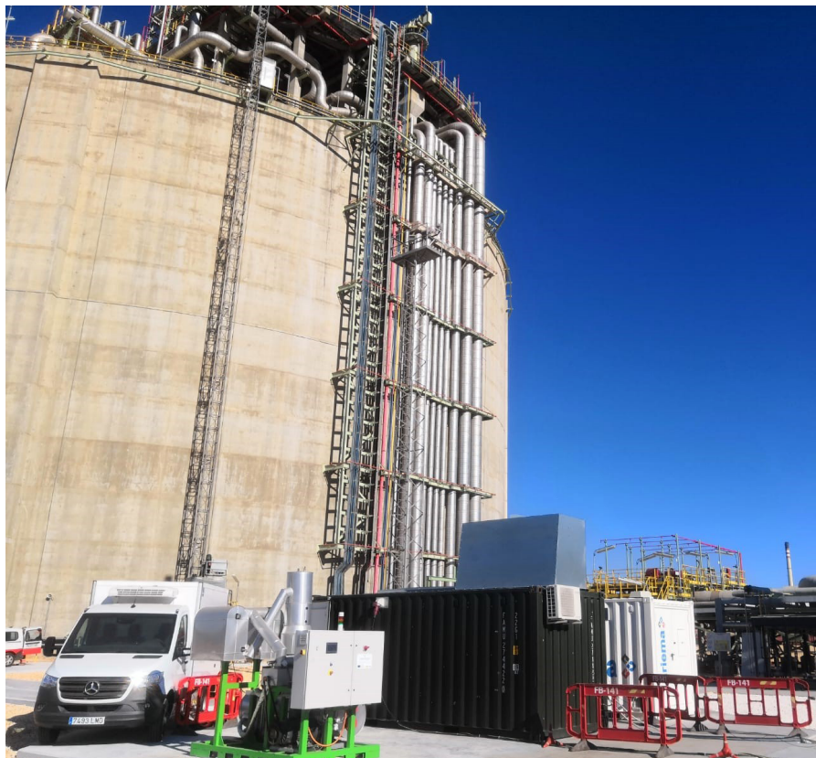
Pilotversuche mit Cool Steam zur Erzeugung von grünem Wasserstoff durch Elektrolyse.
